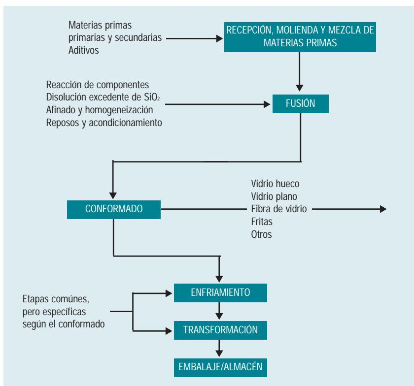
Dependiendo del tipo de vidrio fabricado, las etapas de conformato, enfriamiento y transformación sufren pequeñas variaciones tal y como se indica en los siguientes diagramas de flujo:
